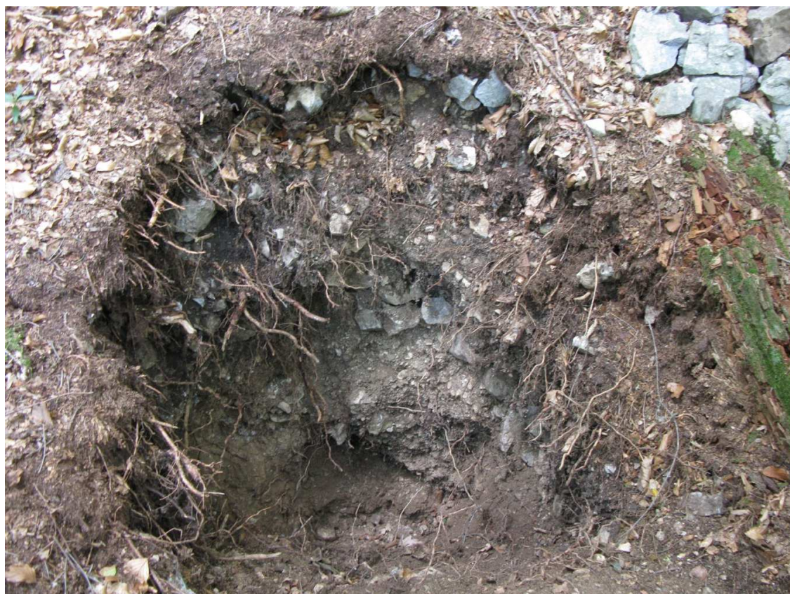
Obr 1: Profil kopané sondy I v horní části zamýšlené trasy vodovodu (foto R. Novotný, červenec 2012).
